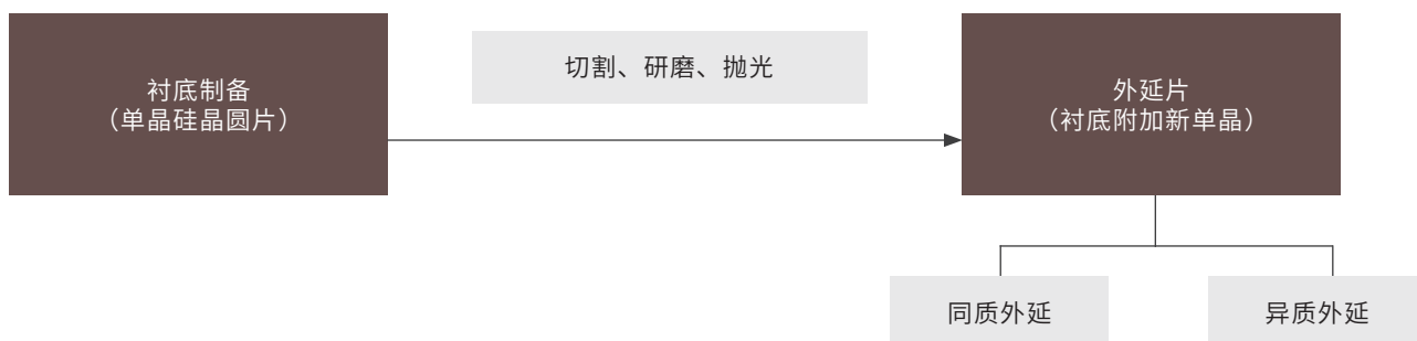
(图：硅晶圆制造过程)
